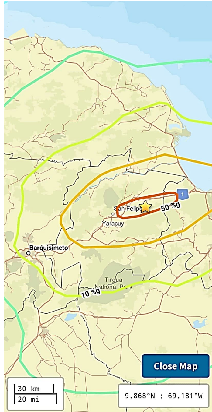
Fig.2. Falla de Morón y aceleraciones máximas esperadas estimadas.
