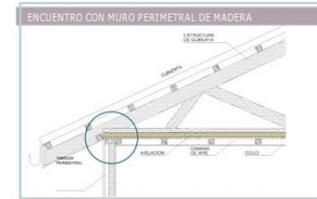
d) Para obtener una continuidad en el aislamiento térmico de la techumbre, todo muro o tabique que sea parte de ésta, tal como lucarna, antepecho, dintel u otro elemento que interrumpa el acondicionamiento térmico de la techumbre y delimite un local habitable o no habitable, deberá cumplir con la misma exigencia que le corresponda al complejo de techumbre, de acuerdo a lo señalado en la Tabla 1 del Artículo 4.1.10.
